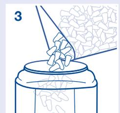
Die neu gestalteten PlugStations können geöffnet und wiederbefüllt werden.
